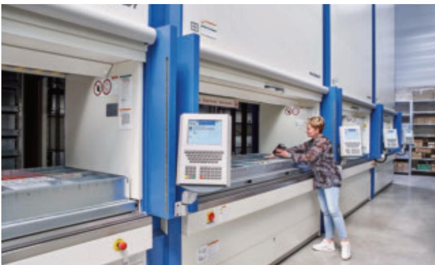
Das Display der Hänel Lift-Steuerung MP12N stellt zusätzlich Artikel und Stückzahlen dar. Die Entnahme wird an der Steuerung quittiert und direkt verbucht.
